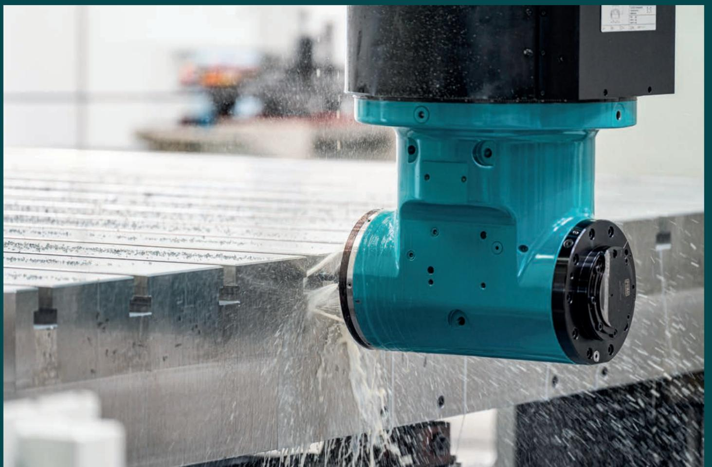
Verspannung und der Spielausgleich durch die NC. Diese Lösungen ermöglichen Achsgeschwindigkeiten bis zu 30.000 mm/min und Beschleunigungen von bis zu 1m/s<sup>2</sup> auf allen Achsen. Auch dem Zubehör wurde besondere Aufmerksamkeit geschenkt: Die Maschine ist mit einem Winkelkopf vom Typ TS 40 V ausgestattet. Dieser besitzt einen separaten Kühl- und Schmierkreis für die Thermostabilisierung. Des Weiteren verfügt die Maschine über einen
